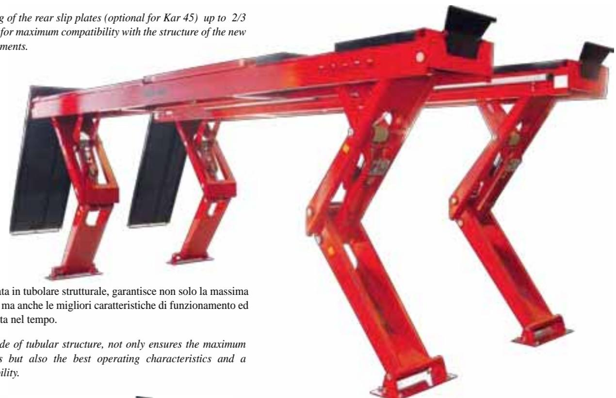
La corsia, realizzata in tubolare strutturale, garantisce non solo la massima rigidità torsionale ma anche le migliori caratteristiche di funzionamento ed una notevole durata nel tempo.
