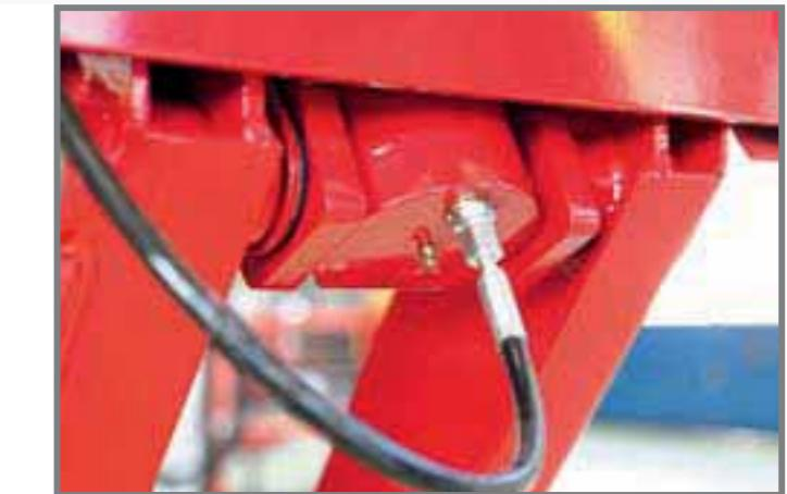
Valvola a paracadute inserita nel fondello di ogni pistone di sollevamento. Tubo idraulico per alte pressioni. Nr. 5 valvole di massima pressione.
