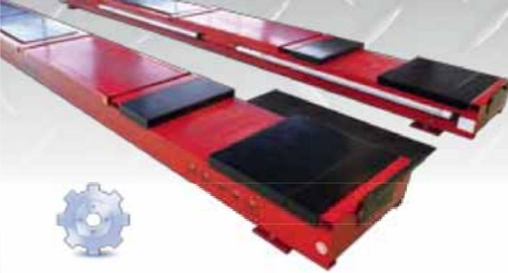
L'incavo anteriore, di generose dimensioni e dotato di appositi pannelli di compenso, consente lo spostamento dei piatti anteriori in varie posizioni così da permettere l'operatività con mezzi di qualsiasi passo.
