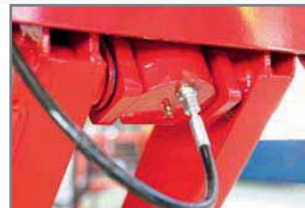
Valvola a paracadute inserita nel fondello di ogni pistone di sollevamento. Tubo idraulico per alte pressioni. Nr. 5 valvole di massima pressione.
