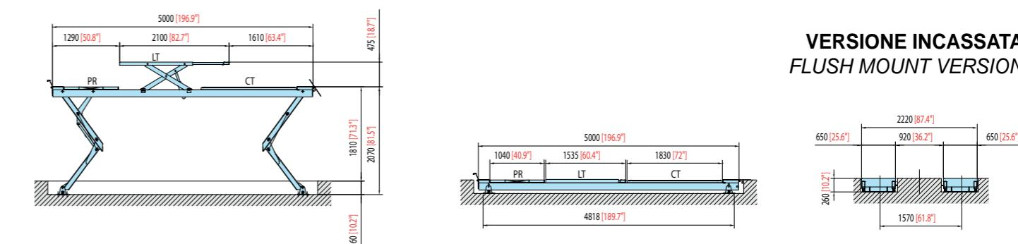
**Il nuovo KAR 45**, è dotato di una corsia da 5.000 mm disponibile rispettivamente in versione N con corsia liscia o CT/LT con incavo anteriore, piattoscillanti posteriori e sollevatore libera ruote con portata di 4.000 Kg.
