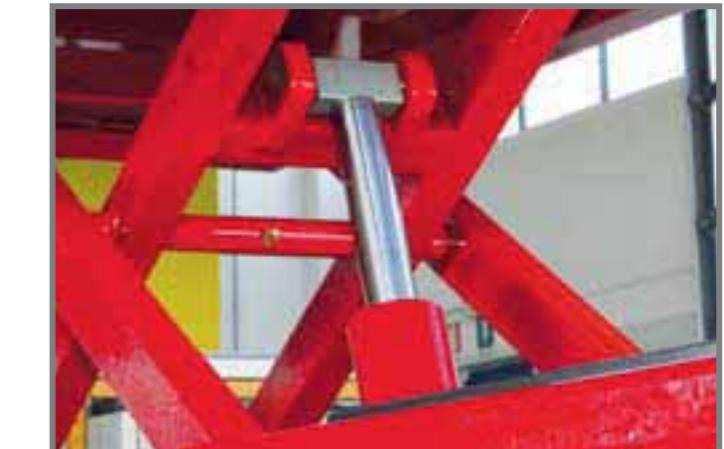
Sollevatore ausiliario libera ruote Lift Table, con pistone idraulico di sollevamento completo di valvole di sicurezza elettrica e a paracadute per la sicurezza in caso di rottura delle tubazioni. Il sollevatore ausiliario LT con portata di kg.3.500 è realizzato in conformità alla nuova EN 1493/ aggiornata agosto 2010.
