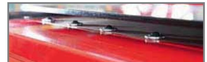
Bloccaggio pneumatico dei piatti oscillanti posteriori (optional per Kar 45) a 2/3 della loro estensione per la massima compatibilità con gli assetti di nuova generazione.
