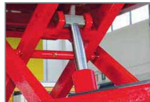
Sollevatore ausiliario libera ruote Lift Table, con pistone idraulico di sollevamento completo di valvole di sicurezza elettrica e a paracadute per la sicurezza in caso di rottura delle tubazioni. Il sollevatore ausiliario LT con portata di kg.3.500 è realizzato in conformità alla nuova EN 1493/aggiornata agosto 2010. Il lift table con una prolunga di ben 2.100 permette di operare anche con mezzi lunghi (compatibilmente con la distribuzione dei pesi)
