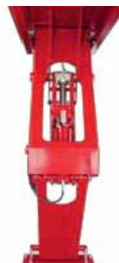
Alloggiamento del pistone nella parte superiore della gamba per proteggerlo contro caduta di sporco dai veicoli e contro le cadute accidentali dei vari attrezzi utilizzati dall'operatore.
