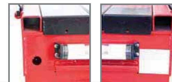
Fotocellula per il controllo del parallelismo delle corsie.
