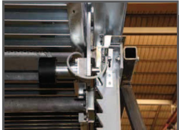
En outre, la machine est dotée d'un bloc électromagnétique d'accrochage à la crémaillère qui permet de sécuriser la machine sur tous les niveaux.
